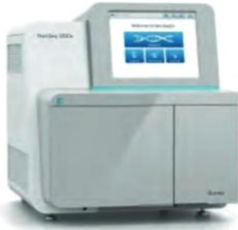
Machine automatisée de séquençage haut débit. La capacité de séquençage est de plus de 300 millions de paires de bases en une seule analyse prenant moins de 35 heures. Par comparaison, le génome humain fait 3 milliards de paires de bases.
